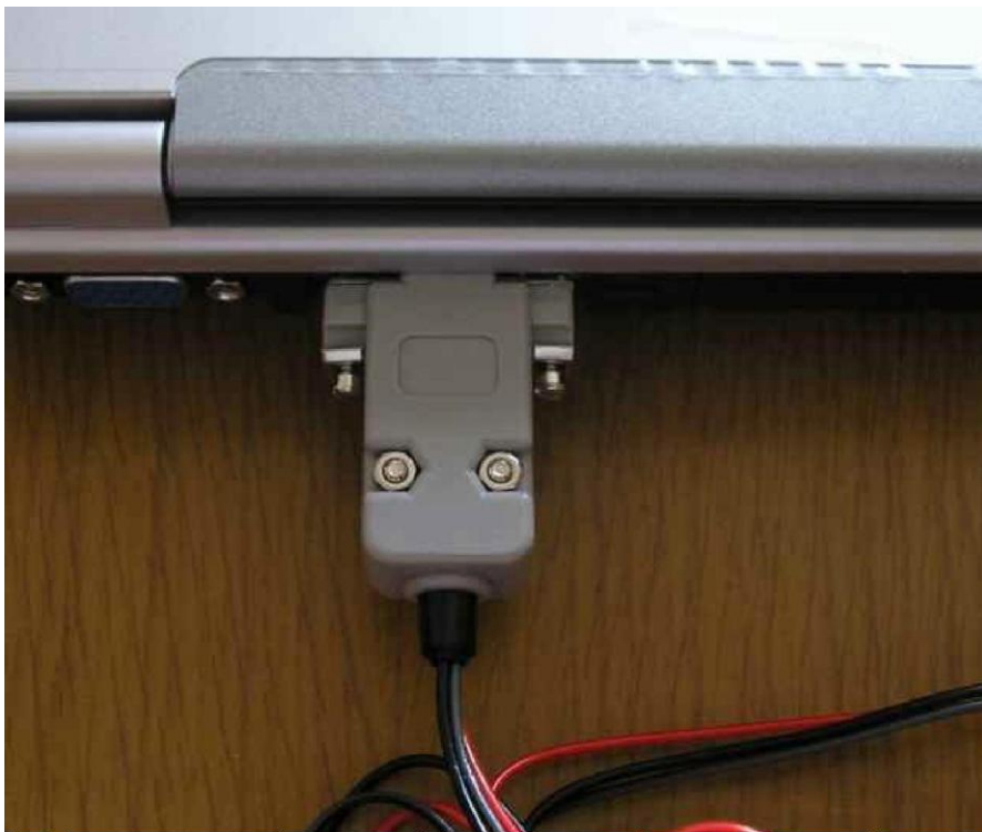
Фото 2. Подключение адаптера к COM-порту персонального компьютера
