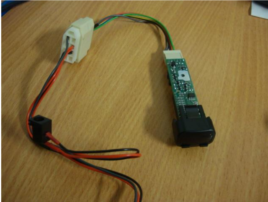
Фото 3. Подключение адаптера к БК через переходник (в комплектацию не входит)
