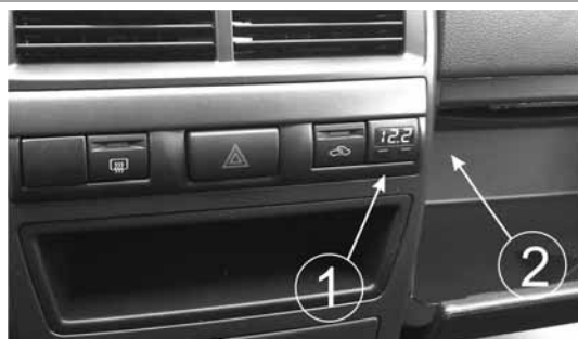
Рис.6 Вид установленного БК
