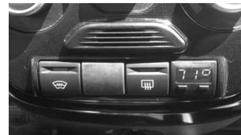
Рис.5 Вид установленного БК
